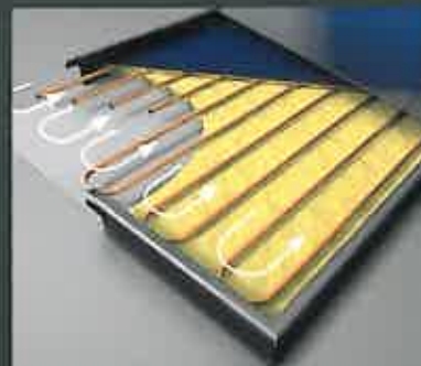
Tubazione a serpentina all'interno del collettore per evitare la formazione di sacche d'aria
