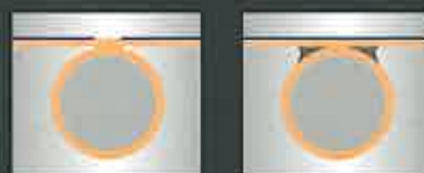
Confronto tra un giunto saldato e un giunto brasato: processo di saldatura standard (a sinistra) e processo di brasatura dolce Schüco (a destra)
